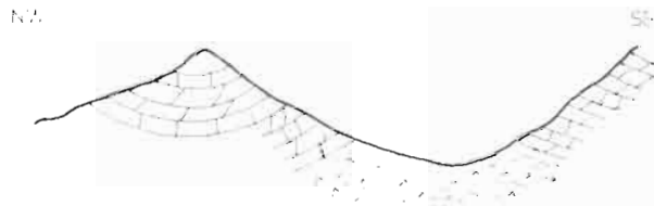
Fig. 16: Corte esquemático realizado en la Cañada del Provencio. Los materiales triásicos se sitúan en el valle constituyendo el núcleo de un anticlinal; los liásicos forman un sinclinal colgado.
