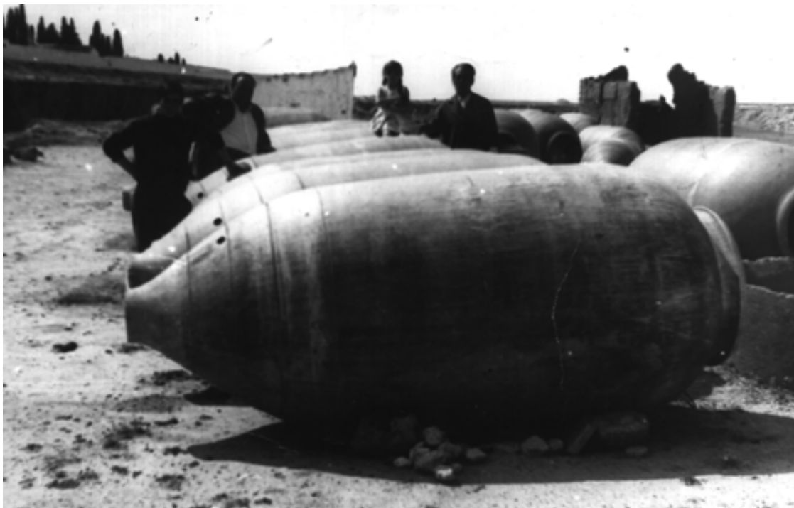
Tinajas preparadas para instalar en las bodegas
