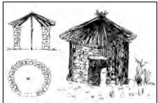
Foto 5. Esquema de una bujarda de Encinasola (Huelva), según E. Hernández León, tomado de Una arquitectura...
