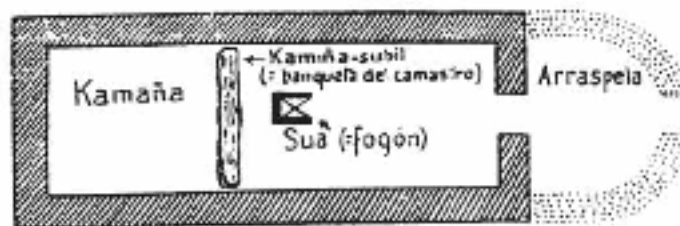
Fig. 8.- Inguiñau (Gorbea): croquis en planta de una choza o txabola antigua.
