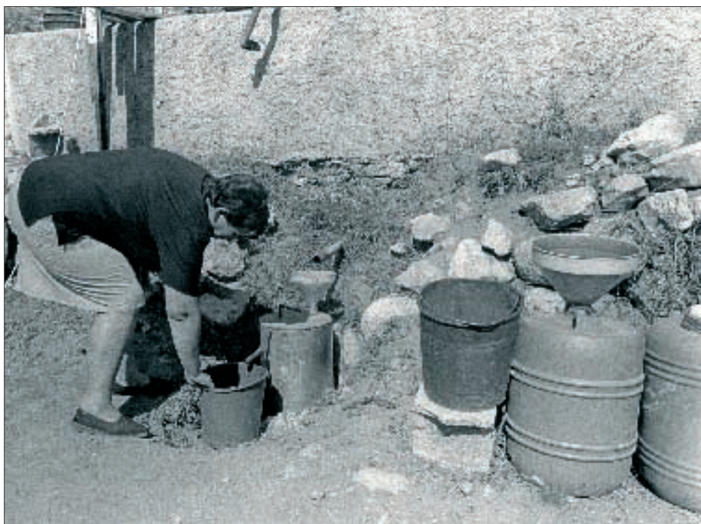
La esencia a través de los tubos del serpentín cae a las garrafas.
