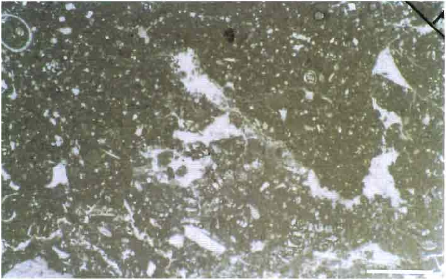
Foto 3. Wackestone de fósiles, parcialmente recristalizado. Foraminíferos bentónicos y algas principalmente. Mb. Malacara de la Fm. Caroch. Escala 1 mm.
