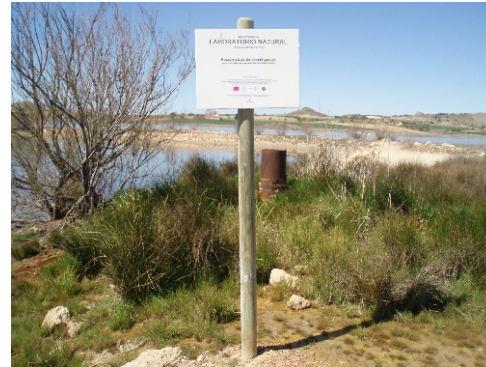
Laboratorio Natural de la Laguna de Pétrola. Está formado por varios sondeos hidrogeológicos donde se monitorizan periódicamente los flujos de agua subterránea y su composición química.
