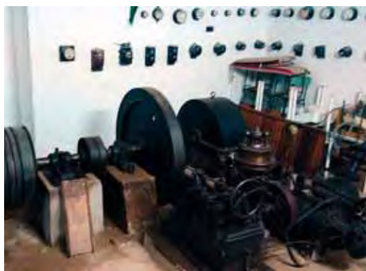
Fig. 123.- Turbina del tipo "pelton" de la central hidroeléctrica (fotografía de Emilio Romero Esteban)
