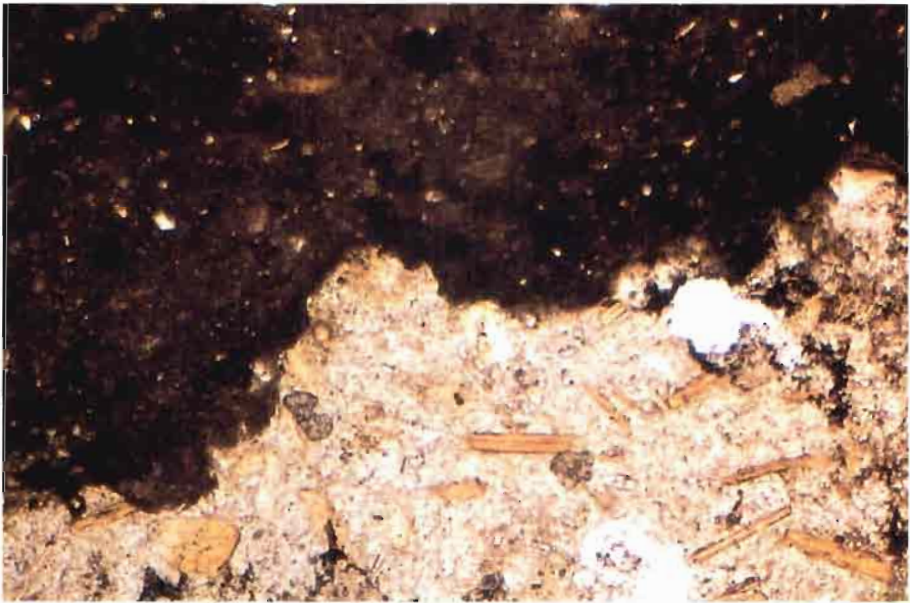
Fotografía CMV.2. Microfotografía en la que se observa el contacto irregular entre fragmentos piroclásticos (roca lamproítica con fenocristales de flogopita) y micrita algo arenosa lacustre. Proximidades del Cerro del Monagrillo. N/7, x55.
