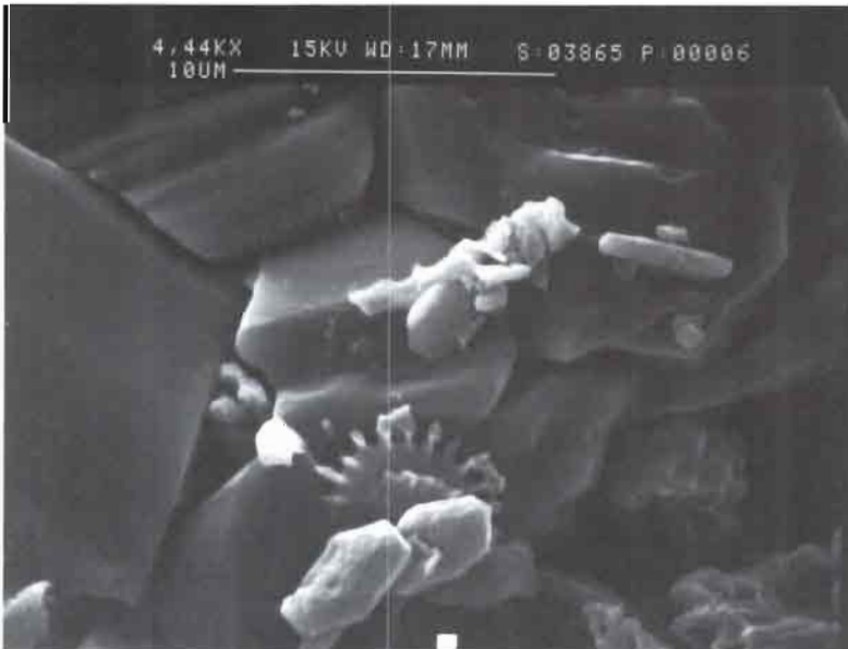
Fig. -15: Detalle de la fotografía anterior en la que se observa la frústula disuelta de diatomita. Imagen de Microscopía Electrónica de Barrido.
