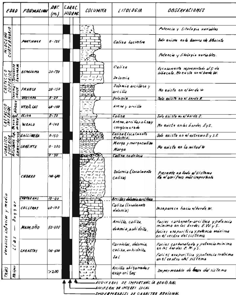
Fig. 2.— Columna litológica sintética. Sistema hidrogeológico de Albacete (según L. Linares y M. Senent, 1975)
