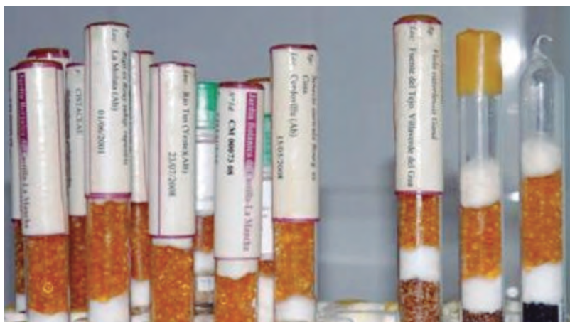
Figura 4. Gradilla con tubos sellados a la llama, listos para ser refrigerados, en la que se puede observar la protección del punto de soldadura con un tapón de cera.
