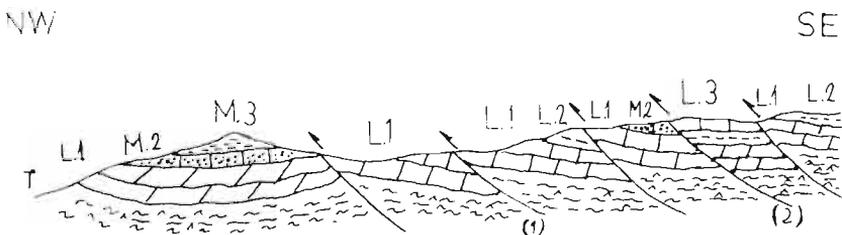
Fig. 13: Corte esquemático donde se observa el sinclinal de Vianos y la zona de escamas; no se ha dibujado el anticlinal a causa de su pequeña magnitud. Con los números 1 y 2 se indican las escamas de las paradas 11-1 y 11-2 respectivamente.
