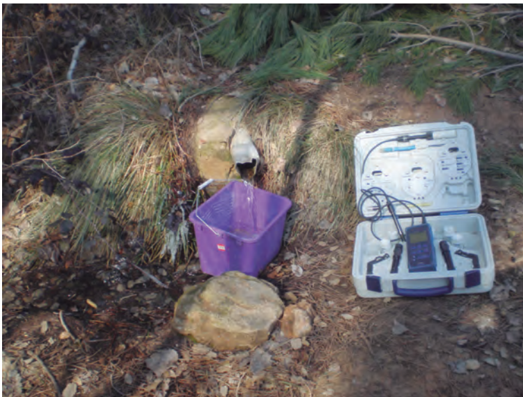
Figura 8. Ejemplo de toma de muestras y análisis físicoquímicos. Manantial de La Manchega, proximidades de la central hidroeléctrica de la Manchega.
