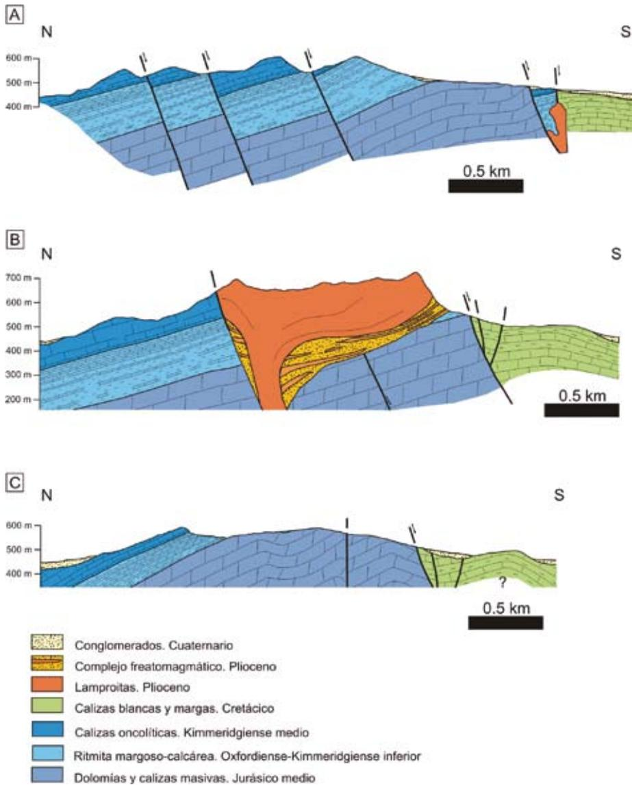
**Figura 22:** Cortes geológicos que ilustran la estructura tectónica de la Sierra de las Cabras. A. Corte al Este del volcán de Cancarix. B. Corte que atraviesa el volcán de Cancarix. C. Corte al Oeste del volcán de Cancarix. Localización de los cortes en la Figura 2.
