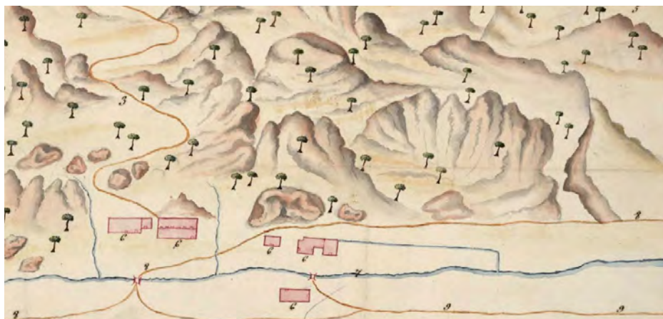
Figura 1. Fragmento del Plano del Coto e la Mina (1817-1821) de A. Larramendi J.A. Larrúmbide en donde se pueden observar el camino de descenso de las minas de San Jorge, junto a los talleres y un canal de servicio para el procesado minero. Archivo General de Simancas
